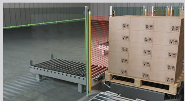
Smart Process Gating an einer Förderstrecke
